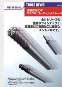
La fresa Miracle VCMD permite el mecanizado de aceros con una dureza superior a 60 HRC
